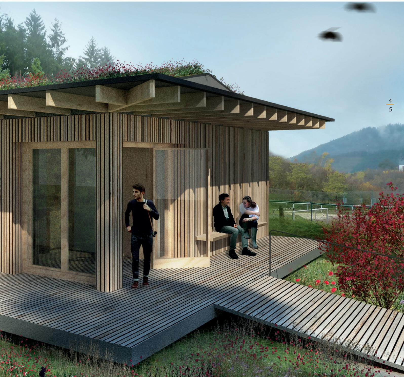
Der 135 Quadratmeter große Baukörper in Holzbauweise erhält eine wartungsfreie Fassade aus unbehandeltem Lärchenholz, das durch die Witterung auf natürliche Weise vergrauen wird.
